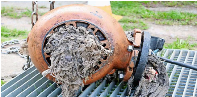
Ergebnis: Verstopfungen in den Pumpen
